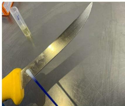
Figura 14 – Procedimento de fricção do swab sobre a superfície da lâmina da faca. Fonte: arquivo pessoal.
