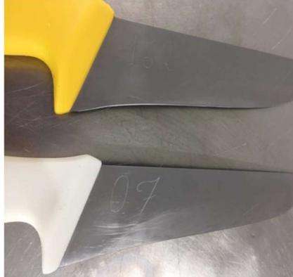
Figura 13 – Marcação numérica na lâmina das facas. Fonte: arquivo pessoal.
