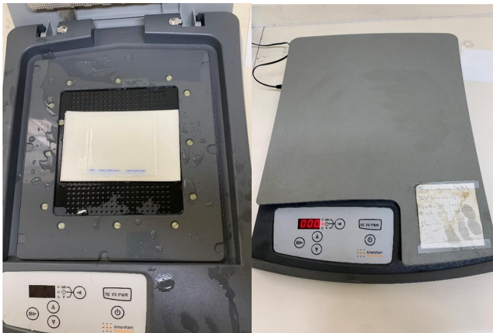
Figura 10 . Membrana de nitrocelulose sendo preparada e equipamento de Western Blotting da marca Amersham (Foto: Gabriele D. G. Ladeira,2023).
